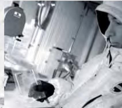
Preparación de muestras de hielo para analizar la microestructura
