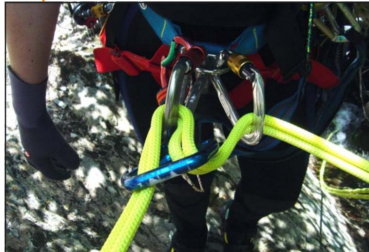
Será asimétrico y desempeñará la función de frenado adicional en el descenso de los rápeles, sobre todo cuando exista bastante metraje de cuerda, y/o según el tipo de cuerda que usemos.
