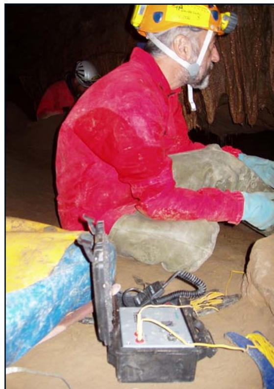
cluyendo dos cables de 25 metros y una pareja de electrodos de acero inoxidable de 25 cm de longitud. El equipo electrónico principal se transporta en una maleta estanca (IP 67) de dimensiones aproximadas 21x17x9 cm.
