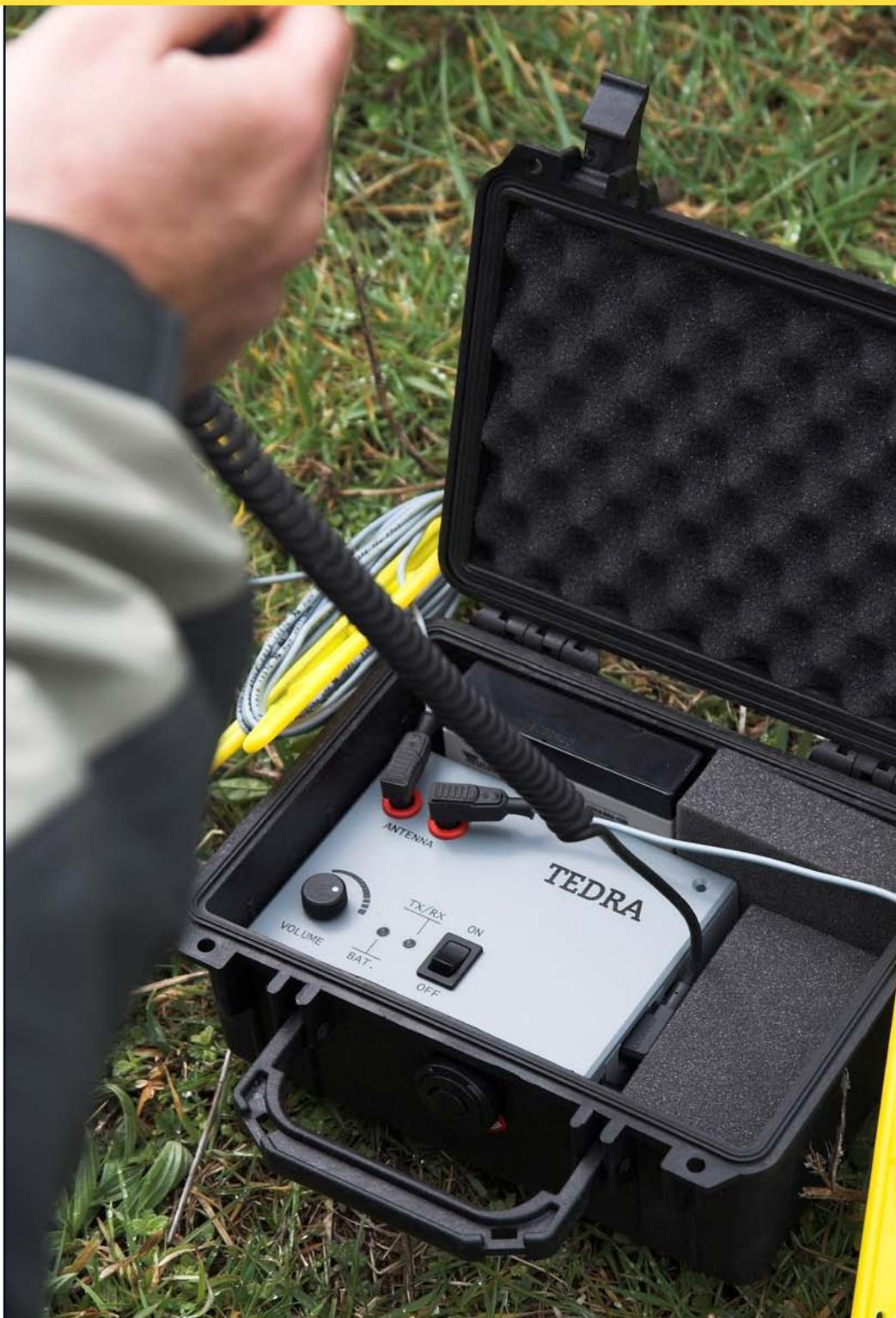
interior, y que en pequeña cantidad alcanza la superficie. La caída de tensión detectada sirve para reconstruir la señal de voz proveniente del equipo interior. Este es el principio básico en el que se fundamenta TEDRA™ para posibilitar las comunicaciones. Por supuesto, el esquema mostrado en la figura 1 puede invertirse de modo que sea el equipo de superficie el emisor (quien inyecta la corriente), mientras que el equipo interior actúa de receptor (detectando la caída de tensión).
