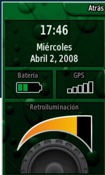
Esta pantalla nos permite comprobar el nivel de batería, la calidad de la señal gps, y regular la intensidad de la retroiluminación de la pantalla.
