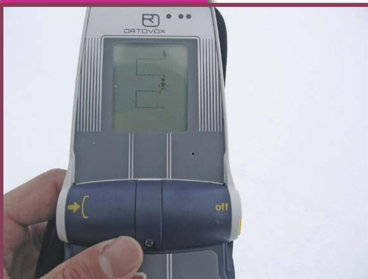
Al encenderlo realiza un chequeo de todas las funciones para constatar algún error. Una vez pasado este test el aparato (abierto todavía) se coloca en posición de recepción. Simplemente con cerrarlo (con la pestaña en "on") conmuta a la posición de emisión, después a la fundación y lo mas cerca del pecho.
