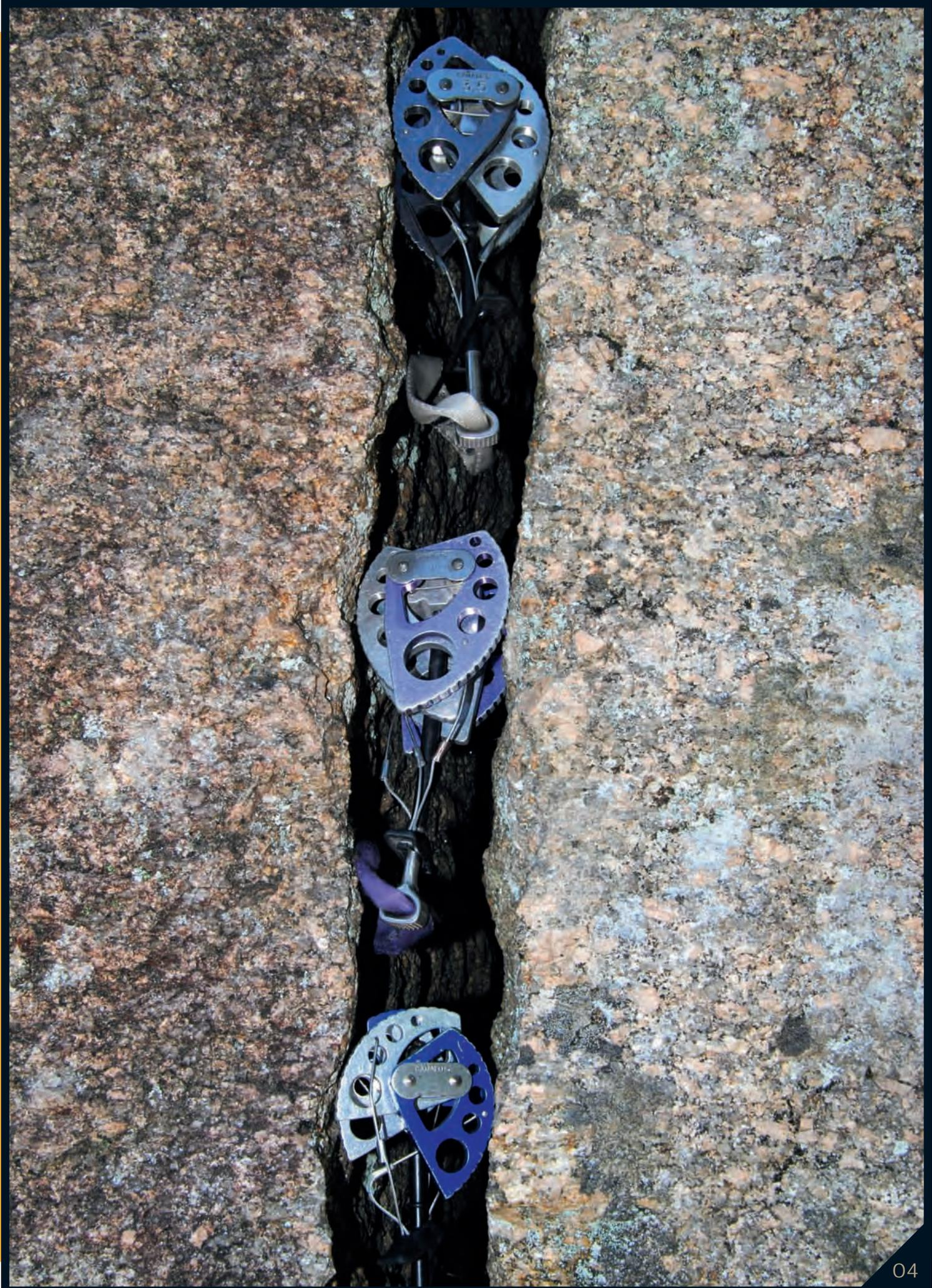
extracción va a ser menos que aquella que nos ofrece una roca granítica o basáltica. Así mismo la calidad del emplazamiento dependerá enormemente en la seguridad de aparato. Si las levas no se hallan en contacto con la pared, o si lo hacen de manera inestable el riesgo a la extracción va a ser mayor.
